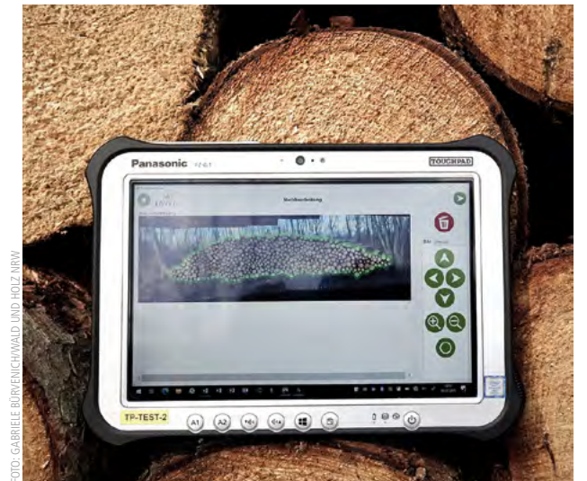
Moderne Form der Holzpoltererfassung: fotooptische Stückzahlermittlung
